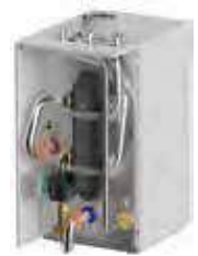
Kit botella de equilibrio Profundidad del kit 275 mm. Ida/retorno 1" 1/2. Conexión gas 1".
